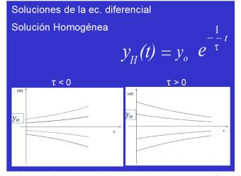
En la práctica, la constante de tiempo de un sistema de primer orden puede obtenerse aplicando una entrada constante Uo al sistema Como en el instante inicial y(0) = 0, de la ecuación diferencial se obtiene
