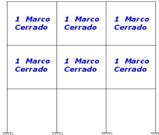
Obsérvese que en este caso será:  $\text{GHVE}=9$  ya que la estructura posee 12 condiciones de vínculo externo de las cuáles cinemáticamente sólo son necesarias 3. En este caso resulta además  $\text{GHVI}=18$  dada la existencia de seis marcos cerrados. Finalmente el  $\text{GH}$  de la estructura es:
