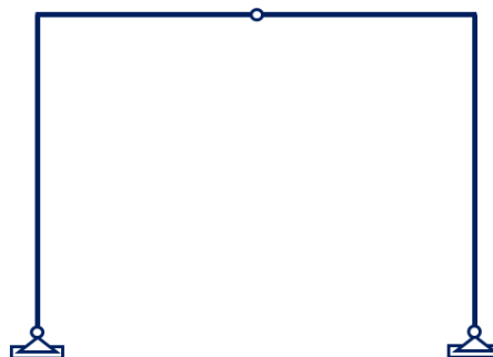
Fig. 8.09.01- CUERPOS VINCULADOS: Pórticos de una nave industrial (foto) y un posible modelo plano para resolverlos, formado por dos chapas
