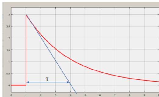
Para entender porqué un sistema dinámico de primer orden tiene una respuesta de este tipo podemos construir el diagrama de integradores a partir de las ecuaciones del circuito eléctrico,
