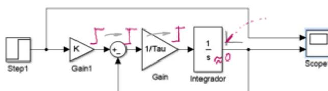
Planteando el diagrama de integradores de  $\ddot{y}(t)+2\sigma\omega_n\dot{y}(t)+\omega_n^2y(t)=Ku(t)$  vemos que en el momento inicial tanto la salida como su derivada son nulas, lo que se refleja en el modo en que se establece  $y(t)$ , sin un cambio abrupto de pendiente.
