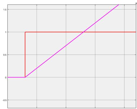
Planteando el diagrama de integradores de  $\tau \dot{y}(t) + y(t) = Ku(t)$  vemos que, como  $y(0) = 0$ , el flanco se trasmite al integrador y se comporta (en este instante) igual que en lazo abierto. (Posteriormente, a medida que  $y(t)$  crece, la amplitud de la señal sobre el integrador disminuye y por lo tanto también disminuye progresivamente la pendiente. Finalmente, la respuesta esponencial llegará al equilibrio con pendiente nula).
