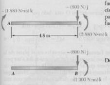
b) Sistema fuerza-par en B. Se pretende encontrar un sistema fuerza par en B equivalente al sistema fuerza-par en A determinado en el inciso a). La fuerza R permanece inalterada, pero se debe determinar un nuevo par  $M_B^R$  cuyo momento sea igual al momento con respecto a B del sistema fuerza-par encontrado en el inciso a). Por tanto, se tiene que
