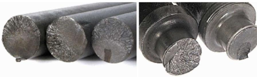
El fallo por fatiga se inicia en muchos casos a partir de una pequeña grieta o defecto (superficial o interno). Esta grieta va agrandándose con la aplicación de numerosos ciclos de carga, hasta que finalmente la sección resistente del material no es capaz de soportar el esfuerzo y rompe de manera repentina. Las marcas de avance de la grieta son apreciables en muchos casos como pequeñas ondulaciones.
