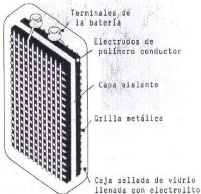
Fig. 3: Batería con electrodos de plástico
